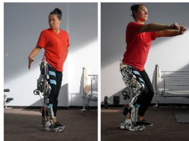
Wynik pracy fundacji Egzotech – rehabilitacyjny egzoszkielet kończyn dolnych
