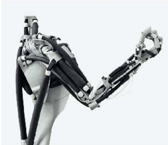
FESTO Airics arm napędzany mięśniami pneumatycznymi
